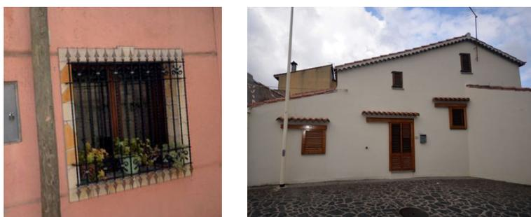
*Lo schema delle forature non rispettoso dei rapporti storicamente rilevati e l'utilizzo di materiali e sistemi di oscuramento non compatibili concorrono ad aumentare l'incompatibilità di edifici storici irreversibilmente modificati o sostituzioni edilizie non del tutto compatibili con il contesto. Un ulteriore elemento di incompatibilità tipologica è data dalla coesistenza di diverse tipologie di infissi nella stessa Unità Urbanistica.*
